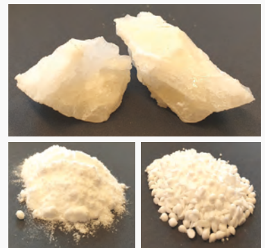
PCM-Proben: Salzhdrate (o.), Zuckeralkohol (u. l.) und Fettsäure (u. r.)
