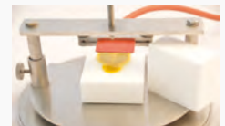
Wärmeleitfähigkeitssensor (gelb) im Probenhalter der Hotdisk mit PCM-Probe
