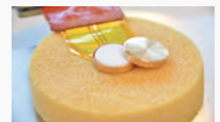
Wärmekapazitätssensor der Hotdisk mit zylindrischer PCM-Probe und Deckel
