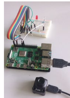
Versuchsaufbau mit Raspberry Pi 4 Model B und Kamera
