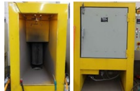
Technologische Umsetzung: Sprühkabine und Trockenofen
