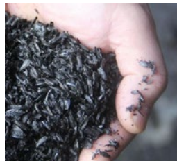
Pflanzenkohle der Firma Sonnenerde auf Basis von Getreidespelzen und Cellulosefasern
