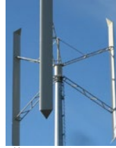
Abb. 1: H-Rotor einer VAWT.
