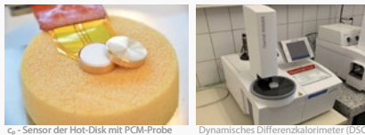
c p - Sensor der Hot-Disk mit PCM-Probe
