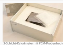
3-Schicht-Kalorimeter mit PCM-Probenbeutel
